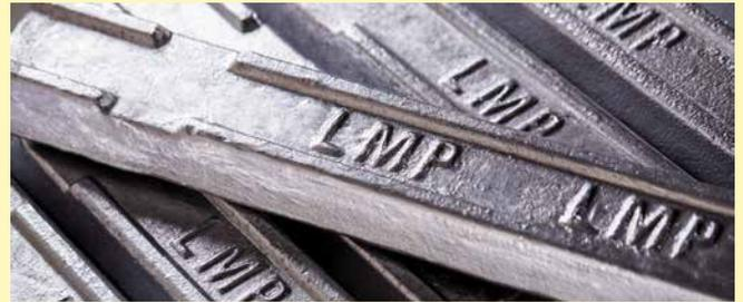
一般定义热传导率在 $150\text{W/m}\cdot\text{K}$ 以上的铝合金可称为高散热铝合金，纯铝的导热系数约为 $240\text{W/m}\cdot\text{K}$ ，而ADC10或ADC12等牌号的压铸铝合金，其热传导率只有约 $90\text{--}130\text{W/m}\cdot\text{K}$ 。
