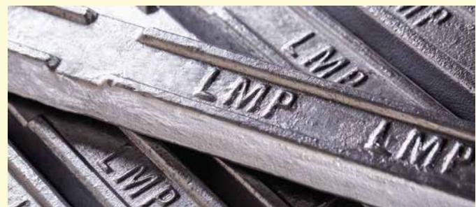
为配合手机行业的最新发展及对新材料的需求，利记拥有丰富经验的技术团队研发高强高导热压铸铝合金的配方，成功做出一种拥有高强度，同时兼备高导热的压铸铝合金ADC10，其性能相对于ADC12如下：
