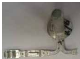
图4：铸件改善后的流道设计
